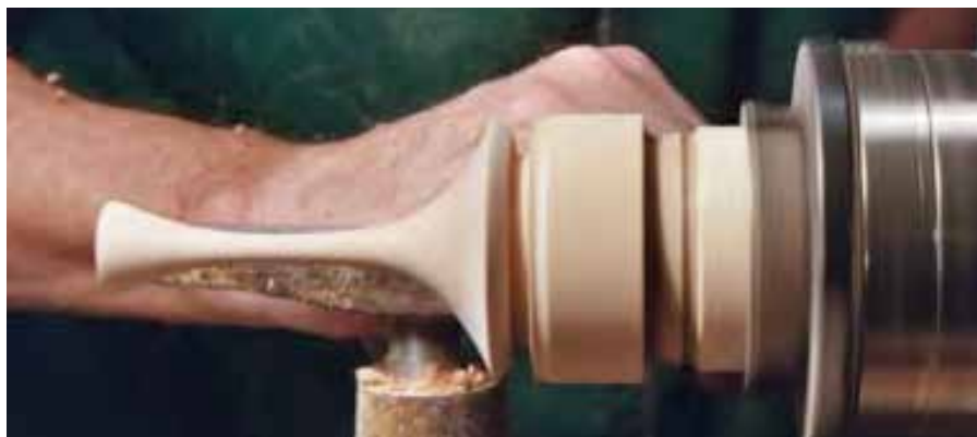
Après le ponçage du pied vous pouvez ébaucher la base du pied avec la gouge à profiler.
