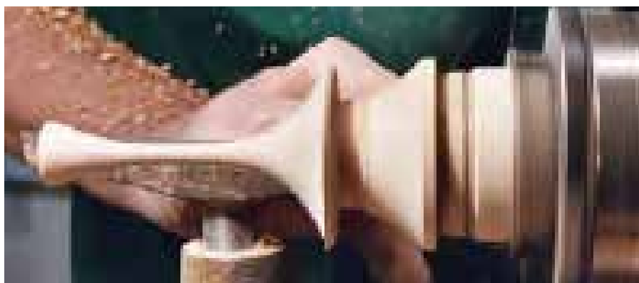
Utilisez la gouge à profiler pour enlever le bois perdu entre le pied et le mandrin. Après cela, vous pouvez tourner le pied légèrement en creux pour avoir une surface stable et agréable.
