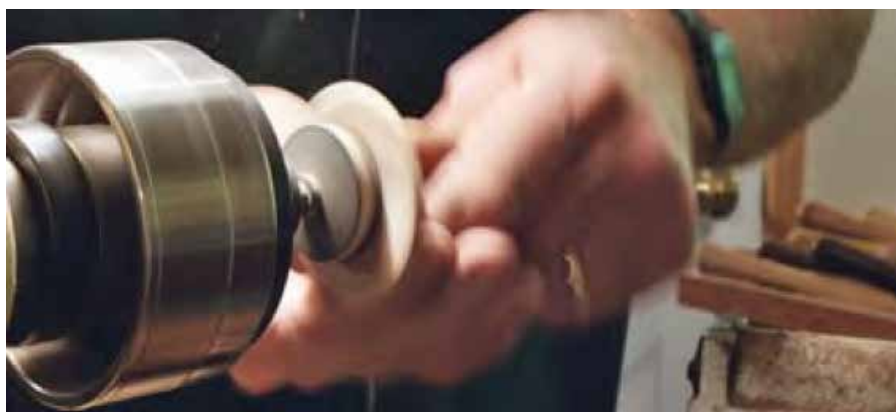
Pour poncer le dessous du pied, montez un petit disque à poncer sur votre mandrin 4 mors.
